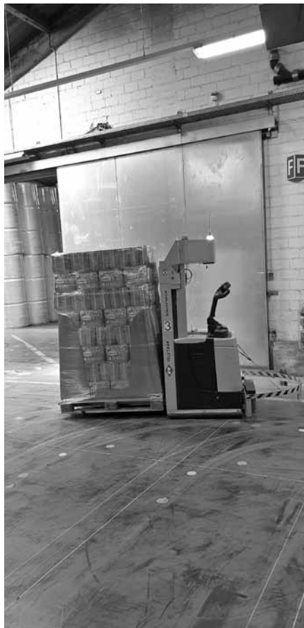
Der fahrerlose Hubstapler, der vom Bütotisch aus programmiert wird.
